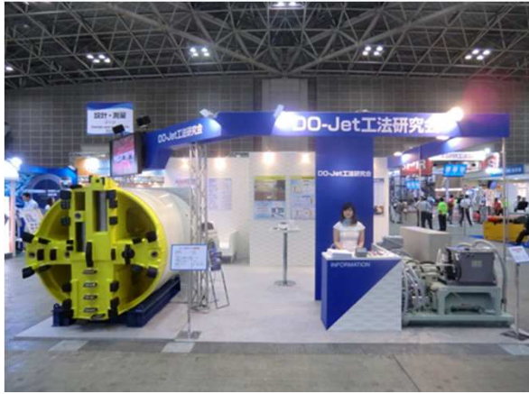
展示ブース正面及び呼び径1350mm推進機
